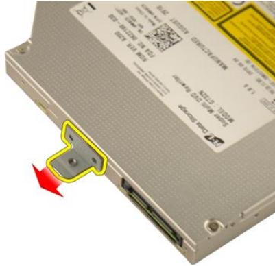
8. Schieben Sie die Halterung des optischen Laufwerks vom Modul des optischen Laufwerks herunter.
