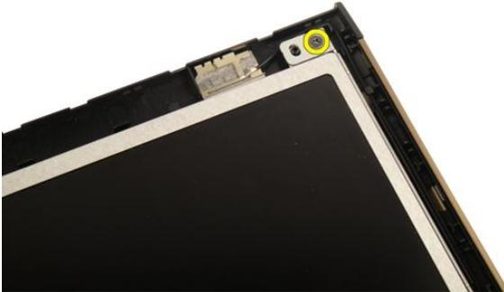
**14.** Entfernen Sie die Schrauben, mit denen die rechte Bildschirmhalterung befestigt ist.
