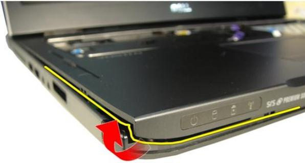
15. Hebeln Sie die Seiten der Handballenstütze auf und entfernen Sie diese.
