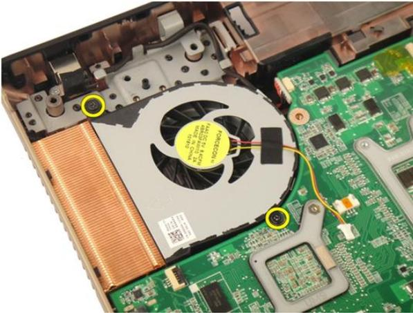
9. Entfernen Sie den Systemlüfter von der Unterseite des Gehäuses.
