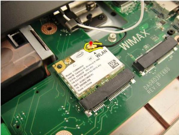
9. Entfernen Sie die Schraube zur Befestigung der WLAN-Karte.
