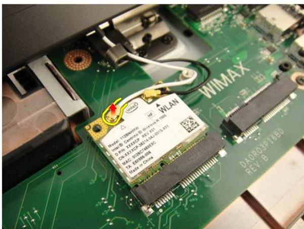
8. Trennen Sie das Antennenkabel von der WLAN-Karte.
