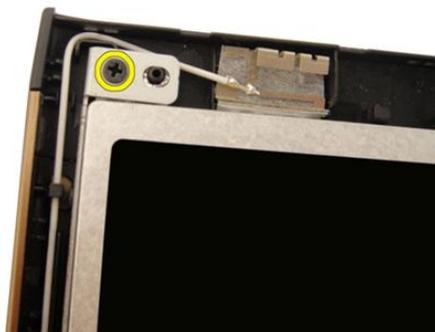
12. Entfernen Sie die Schrauben, mit denen die linke Bildschirmhalterung befestigt ist.
