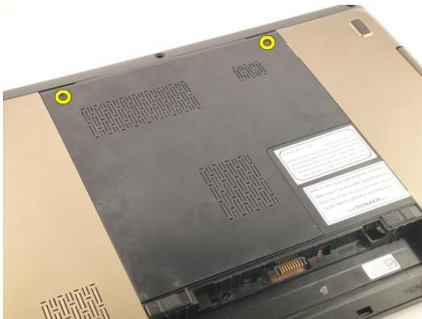
4. Hebeln Sie die Speicherklappe nahe der Schraubenbohrung auf, heben Sie sie an und entfernen Sie sie.
