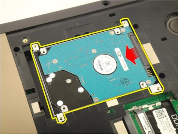
6. Entfernen Sie das Festplattenlaufwerkmodul von der Systemplatine.
