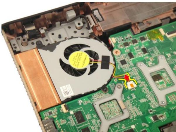
8. Entfernen Sie die Schrauben, mit denen das Systemlüftermodul befestigt ist.
