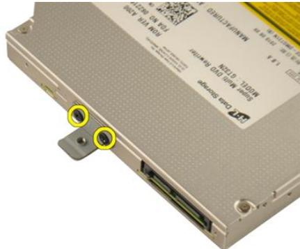
7. Entfernen Sie die Halterung des optischen Laufwerks vom Modul des optischen Laufwerks.
