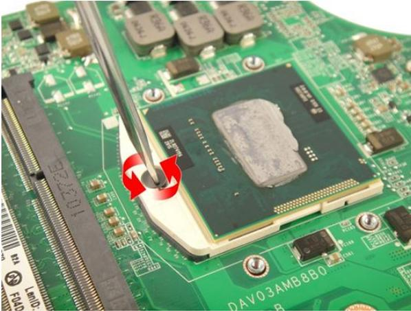
17. Heben Sie den Prozessor gerade aus dem Sockel und verpacken Sie ihn in einer Antistatikverpackung.
