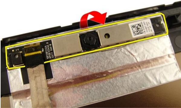
15. Entfernen Sie das Klebeband vom Kameramodul.
