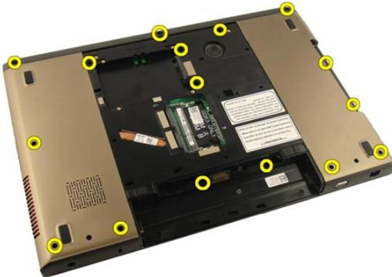
8. Drehen Sie den Computer um und entfernen Sie die Schrauben, mit denen die Handballenstütze befestigt wird.
