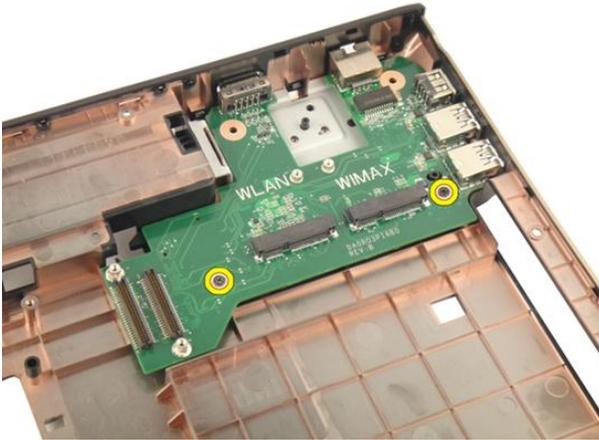
17. Entfernen Sie die E/A-Leiste von der Unterseite des Gehäuses.
