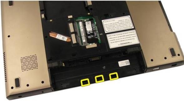
9. Drehen Sie den Computer um und entfernen Sie die Scharnierabdeckung.
