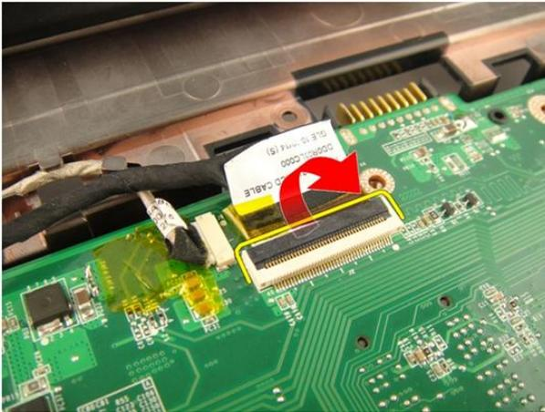
11. Trennen Sie das Kamerakabel von der Systemplatine.
