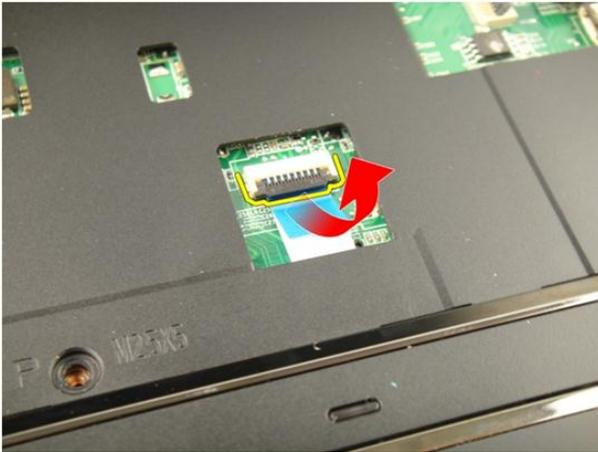
11. Entriegeln Sie die Vorrichtung am Systemplattenanschluss und trennen Sie anschließend das Fingerabdruckleserkabel.
