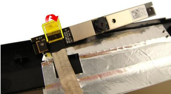
16. Trennen Sie das Kamerakabel und entfernen Sie das Kameramodul.
