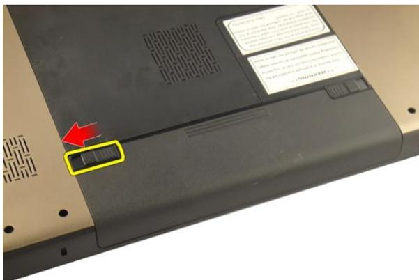
3. Schieben Sie den Akku aus dem Gehäuse heraus und entfernen Sie ihn vom Computer.
